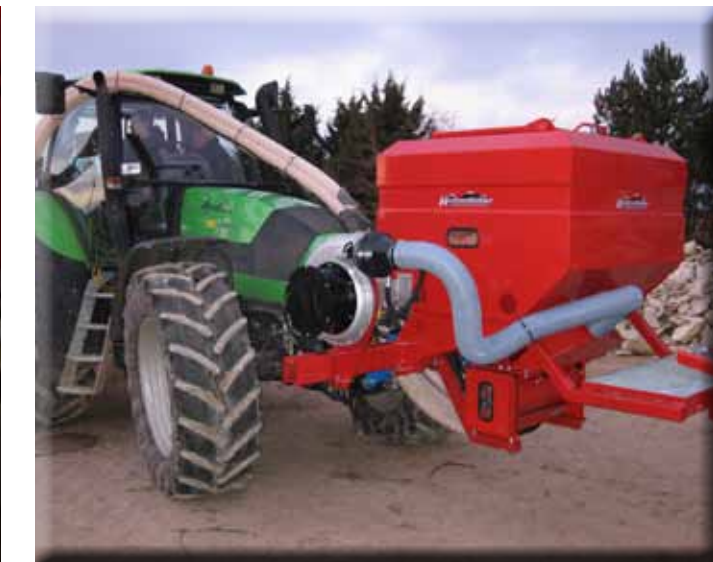
Hatzenbichler „Air 16“ mit 400 L Tank, mit hydraulischem Gebläseantrieb und elektronischer Steuerung
