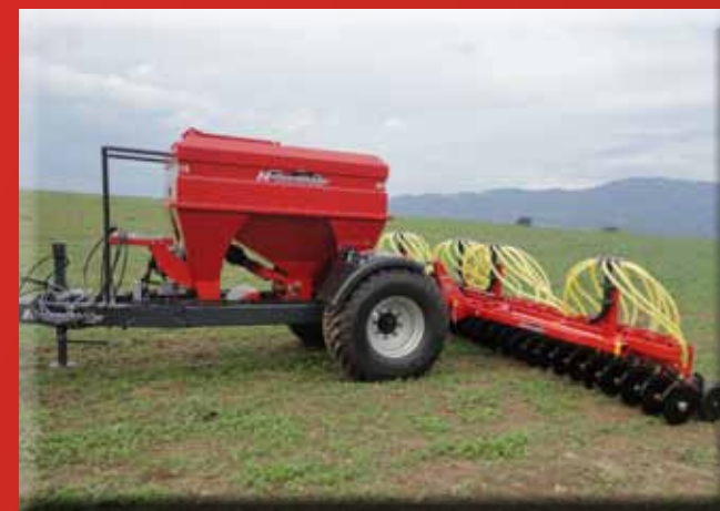
Pneumatisches Sägerät „Air 16“, Aufsattelausführung mit hydraulischem 3-Punkt im Heck, hydraulischer Ventilator, Bordcomputer, Säkasten mit einem Fassungsvermögen von 3000 L. mit Hornet - Serie Sämaschine
