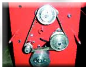
Antrieb vom impuls gesteuerten E-Motor über die Säwelle / Rührwerk, Sensor für Drehzahlüberwachung
