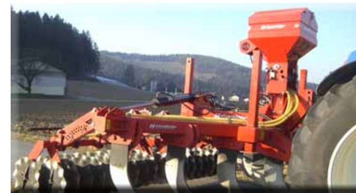
„Air 8“ aufgebaut auf 5-zinkigen Tiefenlockerer Delta zum Ausbringen von Zwischenfrucht
