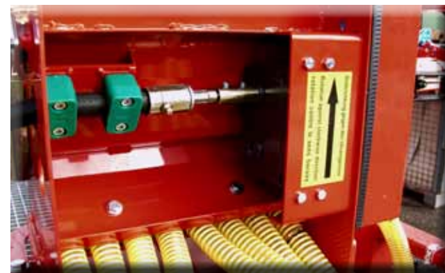
Der Antrieb erfolgt über ein Sporenrad, welches die Kraft über eine biegsame Welle (Ø 12 mm) zum stufenlosen Ölbadgetriebe überträgt.
