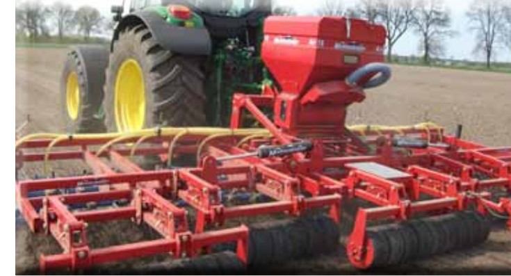
„Air 16“ Aufbau auf 6m Vertikator zur Ein-, Nach- oder Untersaat
