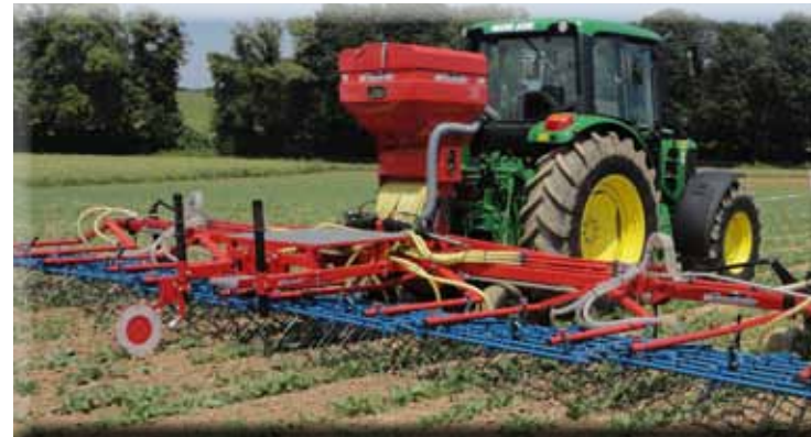
„Air 16“ aufgebaut auf 9,00m Striegel zur Ein-, Nach- oder Untersaat
