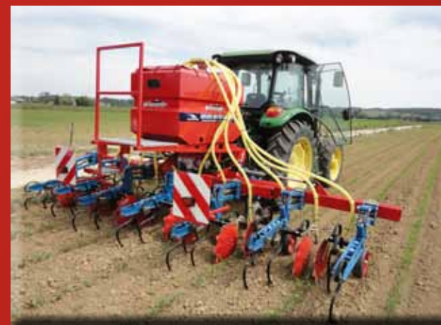
Pneumatisches Sägerät „Air 16“ aufgebaut auf 6-reihige Maishackmaschine zum Ausbringen von Dünger bei gleichzeitiger Unkrautbekämpfung
