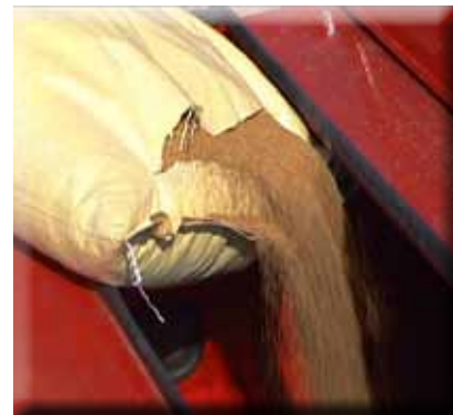
➔ AIR 8 beim Befüllen (große Tanköffnung, großes Sichtfenster)
