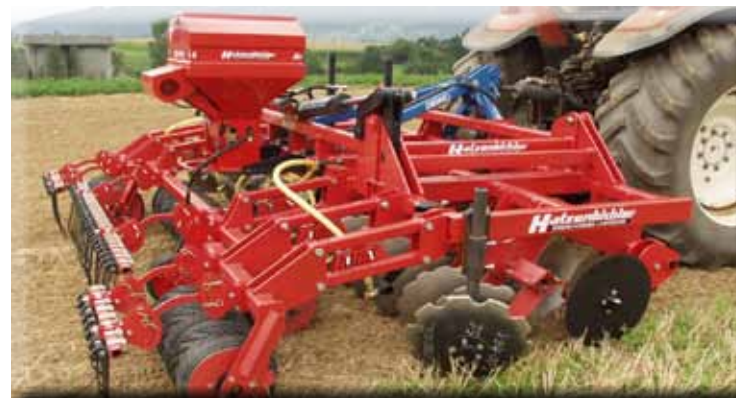
„Air 8“ aufgebaut auf Kurzscheibenegge zum Ausbringen einer Zwischenfrucht
