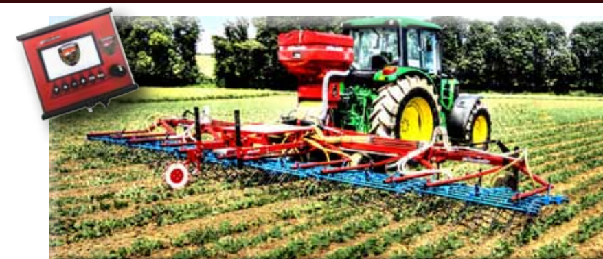
„Original“ Striegel, 9 m Arbeitsbreite, mit pneum. Sägerät „Air 16“ mit Antrieb über Sensorsporenrad oder Radar mit Bordcomputer – Bedienung von der Traktorkabine, 400 Liter Fassungsvermögen, 16 Saauflüsse, geeignet für Arbeitsbreiten bis 12 m. Auch zum nachträglichen Aufbau für Neu- und Untersaat.
