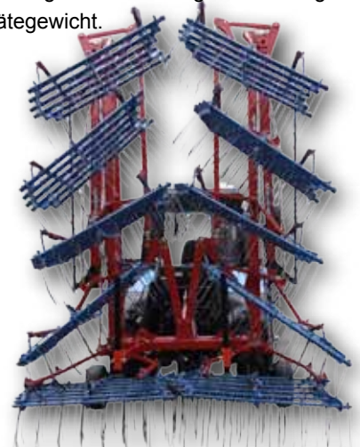
Transportstellung und Scherklappung des Hatzebichler Original Striegel
