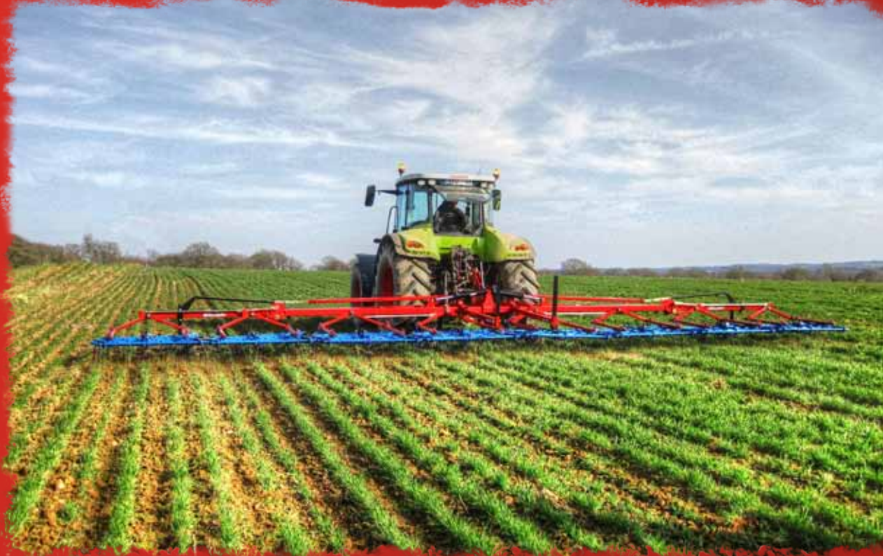
„Original“ Striegel 12m Arbeitsbreite - Einsatz Getreide
