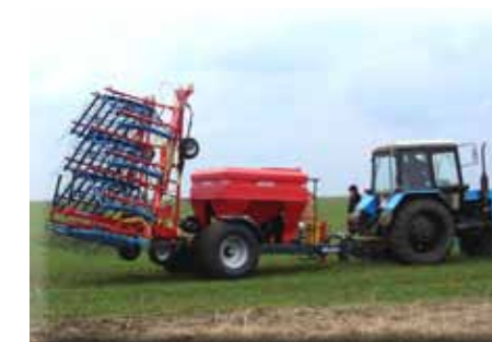
„Original“ Striegel, 15m Arbeitsbreite mit Air Cart Trailer TH 300 - in Transportstellung, 3000 Liter Fassungsvermögen
