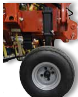
Höhenverstellbares Stützrad mit eingeschraubten Radnaben und Schrägrollenlager.
