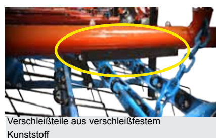
Jedes Striegelfeld ist einzeln an Ketten aufgehängt um die optimale Boden Anpassung zu gewährleisten
