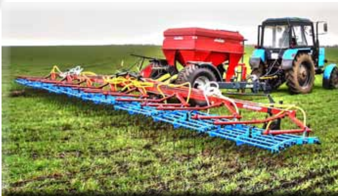
„Original“ Striegel, 15m Arbeitsbreite mit Air Cart Trailer TH 300 - in Transportstellung, 3000 Liter Fassungsvermögen
