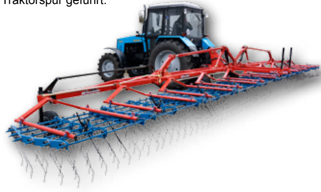
Jedes Striegelfeld ist einzeln an Ketten aufgehängt um die optimale Boden Anpassung zu gewährleisten
