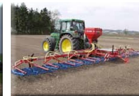
„Original“ Striegel, 15 m Arbeitsbreite mit Air Cart Trailer TH 300 - in Transportstellung
