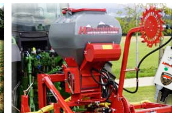
Pneumatisches Sägerät „Air 8“ mit stufenlosem Getriebe 8-teilige Säwelle und 2 Stück Elektro-Gebläse-Motoren. 180 Liter Fassungsvermögen, Antrieb über biegsame Welle mit Sporenrad, Überwachungscomputer. Auch zum nachträglichen Aufbau für Neu- und Untersaat.
