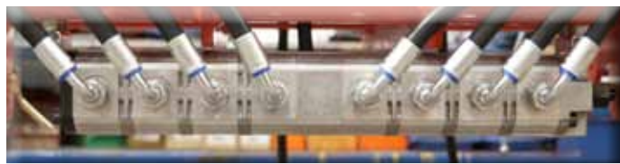
Zahnradmengenteiler für hydraulische Zinkenverstellung
