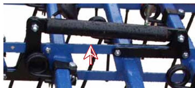
Hydraulische Zinkenverstellung zum Einstellen der Zinkenaggressivität von der Traktorkabine
