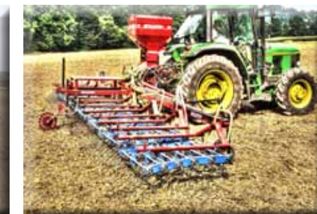
„Original“ Striegel, 9 m Arbeitsbreite, Ausbringen einer Zwischenfrucht
